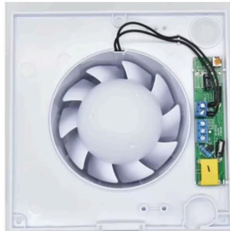
Für den Betrieb des Lüfters wird ein dreiadriges Kabel benötigt, da das Steuerkabel angeschlossen sein muss.
